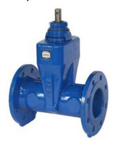
Válvula Fabricada em ferro fundido dúctil e com cunha revestida com elastrômero EPDM, o modelo **Euro 21** de válvula de gaveta são caracterizadas pelo flange em suas extremidades e o corpo longo. Possuem Face a Face de acordo com a norma ISO 5752 série 15, idêntica å simétrica oval da ABNT.
